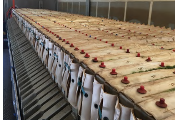
Abb. 8: Klärschlammmentwässerung durch Schnecken- ... und Kammerfilterpresse- presse...
