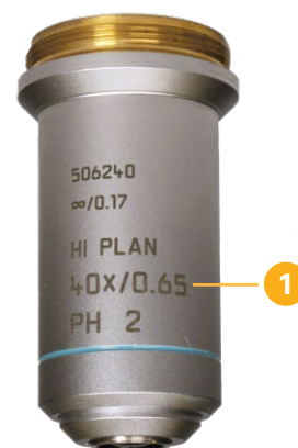
Abb. 3.2: Objektiv mit Beschriftung; Objektivvergrößerung und numerische Apertur (1)
