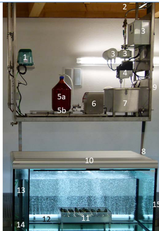
Abb. 14: Aquarium mit technischem Aufbau und Edelstahleinsatz mit Großen Flussmuscheln ( Unio tumidus ) zur Expositi- on mit PVC-Mikropartikeln
