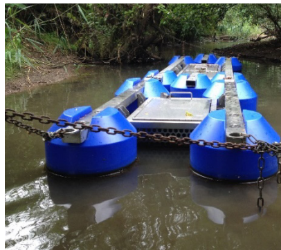
Abb. 9: Der Schwimmkäfig mit den Muscheln wird kontinuierlich vom Flusswasser durchströmt.
