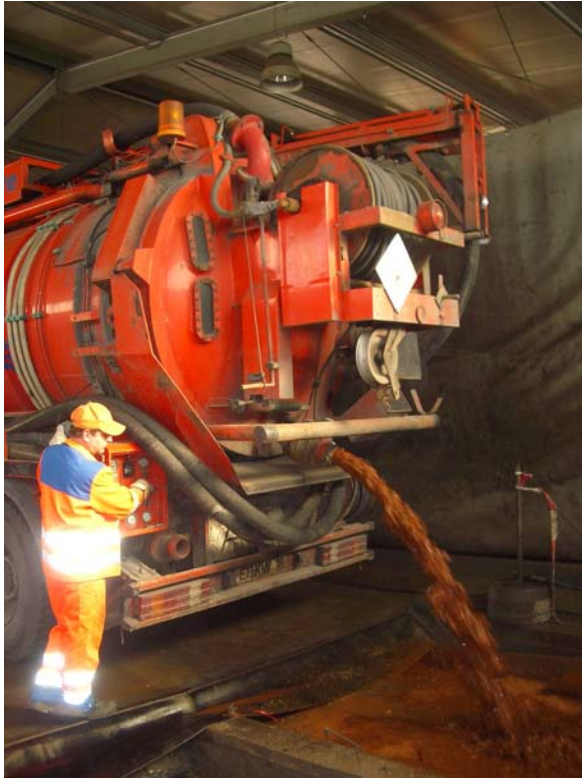
Abb. 35: Entleerung des Saugwagens bei einer Entsorgungsfirma
