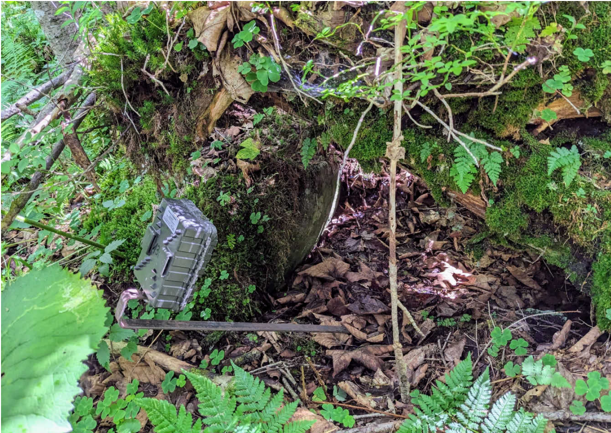
Abb. 3: Untersuchungsgebiet Nationalpark Berchtesgaden; Bodenkamera (an Metallständer befestigt)
