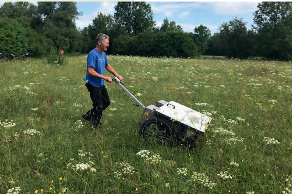
Abb. 31: Mit dem „Wiesefix“ oder „eBeetle“ wird das Saatgut schonend ausgebürstet; die Pflanzen bleiben stehen.
