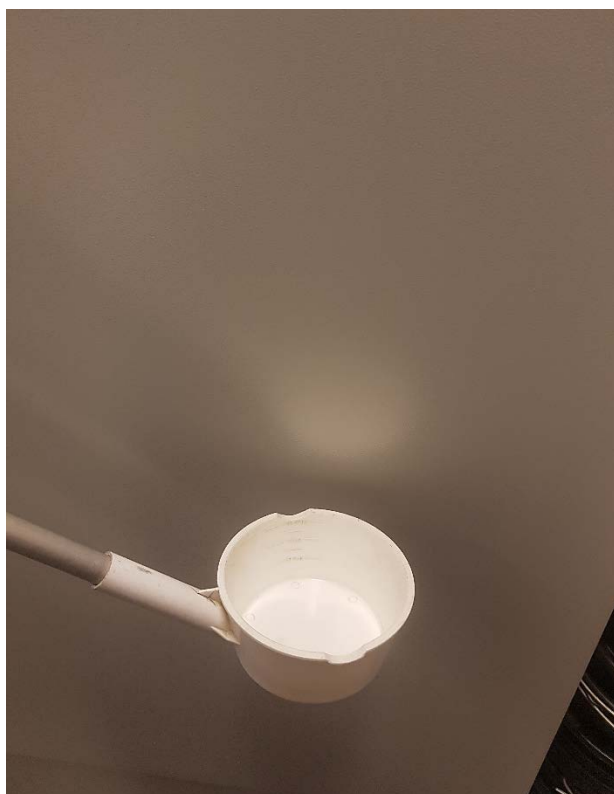
Abb. 9: Standardisierter Dipper der Firma Bio-Quip® mit einem Fassungsvermögen von 350 ml
