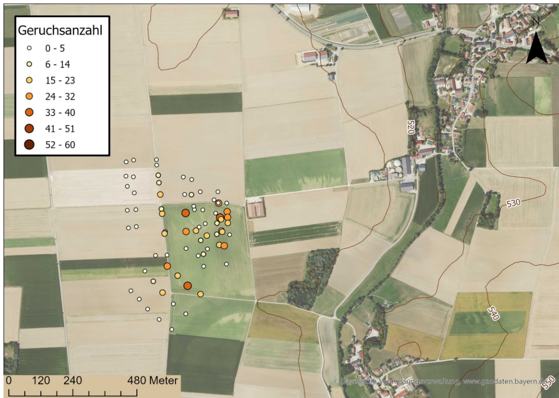
Abb. 45: Ergebnisse der Fahnenbegehung (Sommer) am Mastschweinegestall M1
