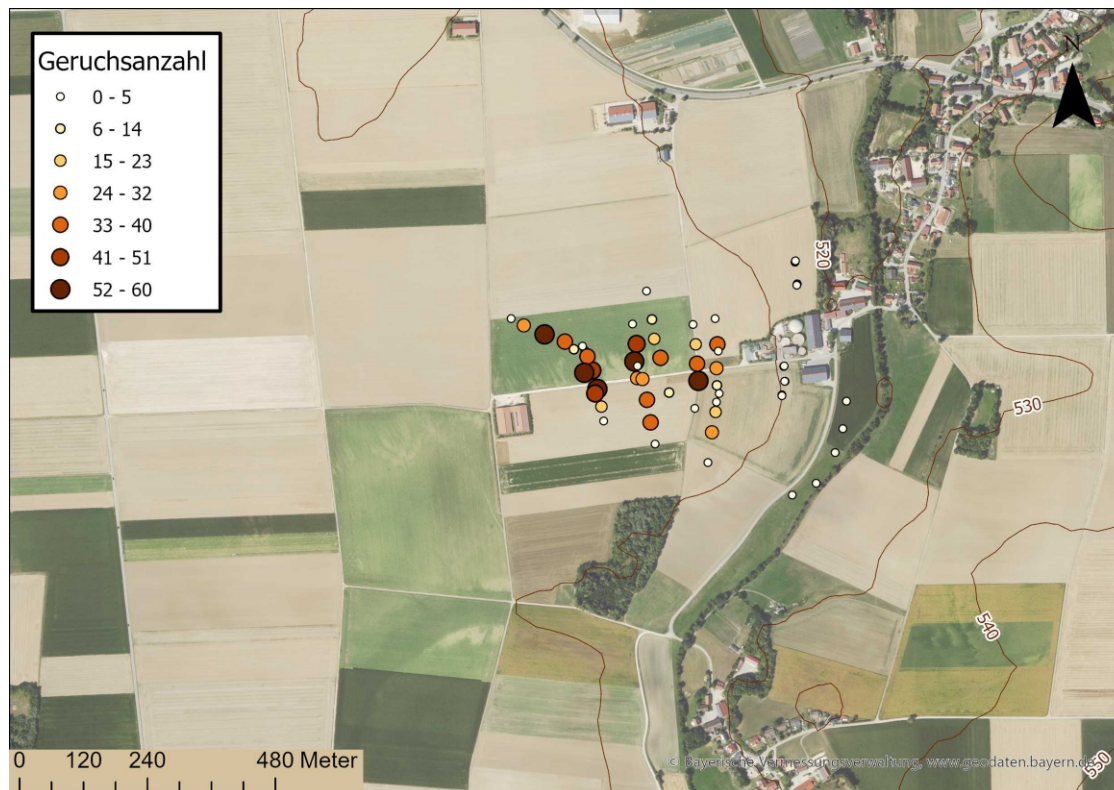
Abb. 43: Ergebnisse der Fahnenbegehung (Frühling) am Mastschweinestall M1
