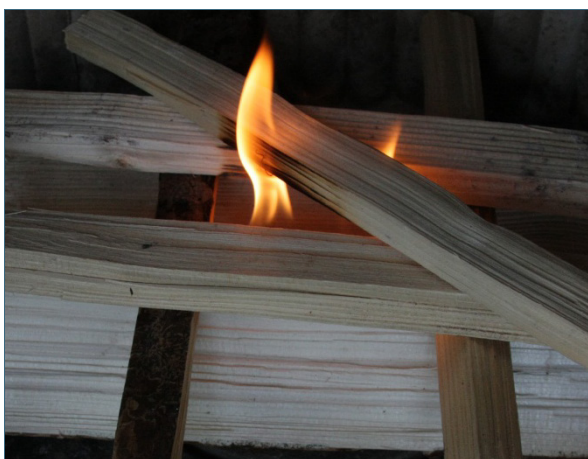
Abb. 8: Wird von oben angeheizt, treten weniger unverbrannte Brenngase aus als wenn von unten angeheizt wird.
