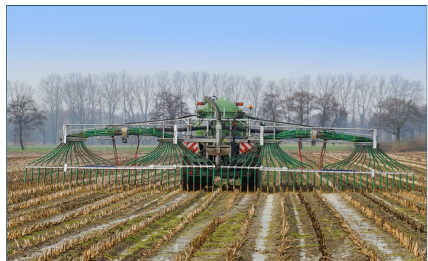
Abb. 3: Günstig ist die Ausbringung mit dem Schleppschlauchverteiler kurz vor dem Regen. Dann sickern Gülle oder Dünger rasch ein.
