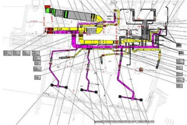
Abb. 16: Viatisschule – Lüftungsschema nach planerischer Optimierung
