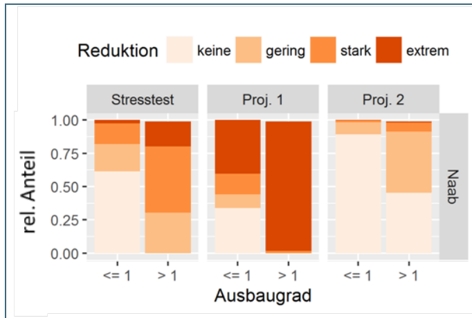
Abb. 12: Stärke der Reduktion für Ausleitungskraftwerke im Naabgebiet in den verschiedenen Simulationen (Projektionen 1 und 2, Stresstest) in Abhängigkeit des Ausbaugrades: Anteil der Kraftwerke in vier Klassen mit "keiner" (< 1 %), "geringer" (<10 %), "starker" (<20 %), "extremer" (>20 %) Abnahme der Energieproduktion
