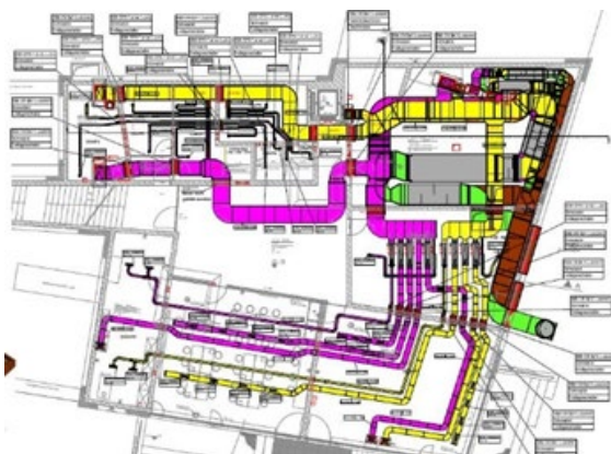
Abb. 11: Viatisschule – Lüftungsschema vor der planerischen Optimierung
