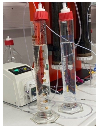
Abb. 24: Beschickung der Säulen mit Versuchslösung (100 µg/l RDX bzw. PTV).
