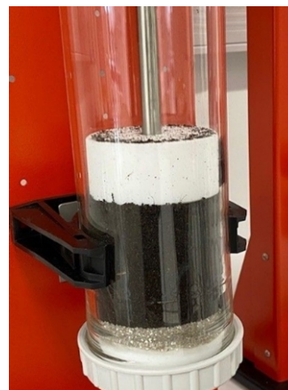
Abb. 21: Einbau und Verdichtung des Komposts.
