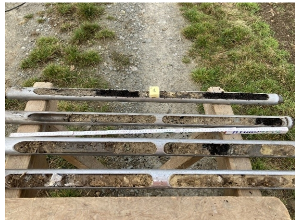
Abb. 8: Bohrkern Rammkernbohrung Trichter T30 mit erkennbarer Schichtung.
