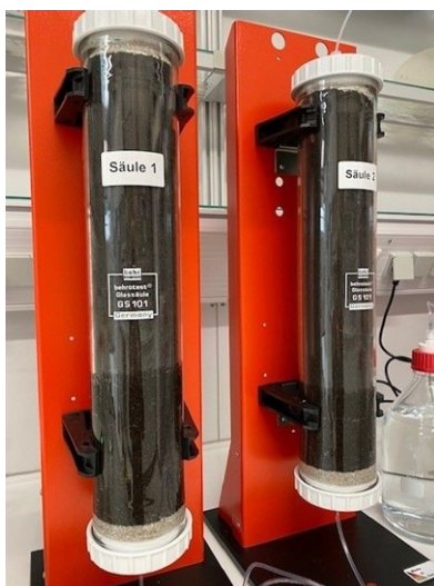
Abb. 22: Säulenconditionierung mit deionisiertem Wasser.
