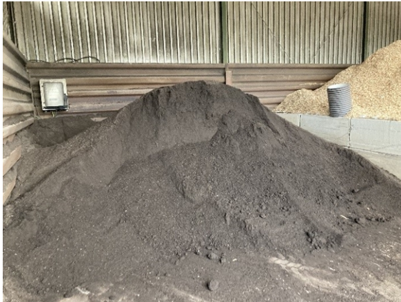
Abb. 18: Kompost (Veolia Fischbach), Rottegrad V, Siebung 0-15 mm.
