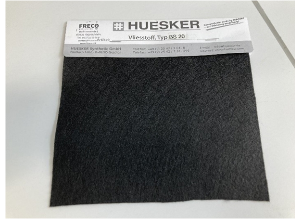
Abb. 40: Vliesstoff BS 20 („Bremsvlies“).
