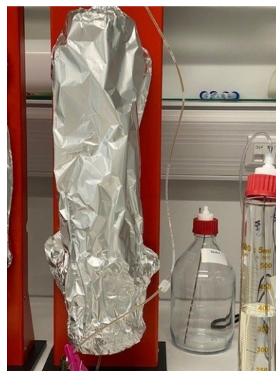
Abb. 23: Lichtschutz während der Standzeiten.
