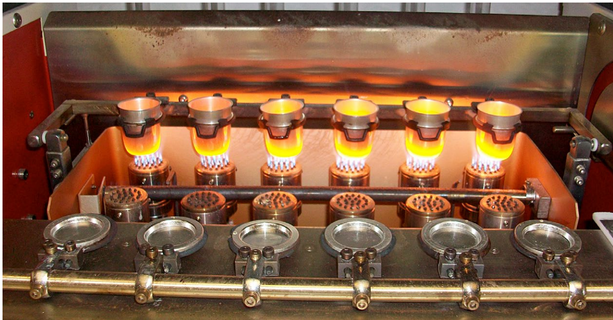
Abb. 25: Herstellung von Schmelztabletten (Aufschmelzen in Platintiegeln) für die anschließende RFA-Analytik (Bild: Activation Laboratories Ltd., Kanada).
