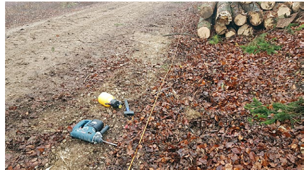
Abb. 29: Einbringen der Elektroden in den Untergrund.
