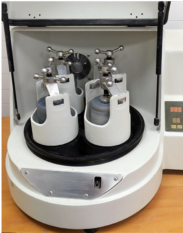
Abb. 23: Geöffnete Planetenkugelmühle mit eingespannten, geschlossenen Achateinsätzen. Diese Achatbecher sind mit Achatkugeln und der aufzumahlenden Probenmenge befüllt.
