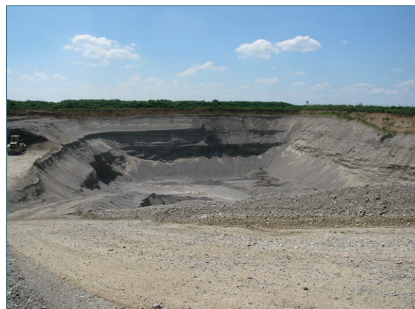
Abb. 22: Kiesgrube Wabern S, Kreuzacker S; Blick nach Westen auf die 23 m hohe Abbauwand, horizontale Ausdehnung des Abbaus ca. 100 m, links neu erschlossene Sohle (9 m) mit Radlader
