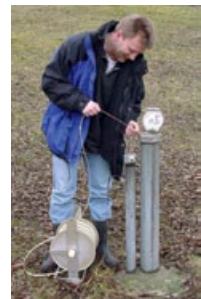
Ein Geologe misst mit einem Lichtlot den Grundwasserstand in einer Messstelle.
