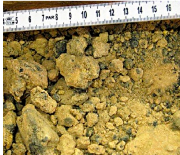
Abb. 5-20: Brauner, schluffig, schwach kiesiger Sand mit schwarzen Flecken aus 12,8 m Tiefe (W10).
