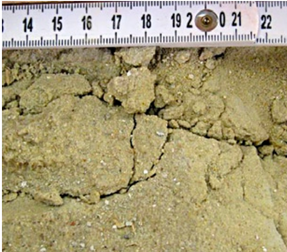
Abb. 5-26: Hellbrauner Fein- bis Mittelsand, muskovit-führend, aus 25,3 m Tiefe (W27).
