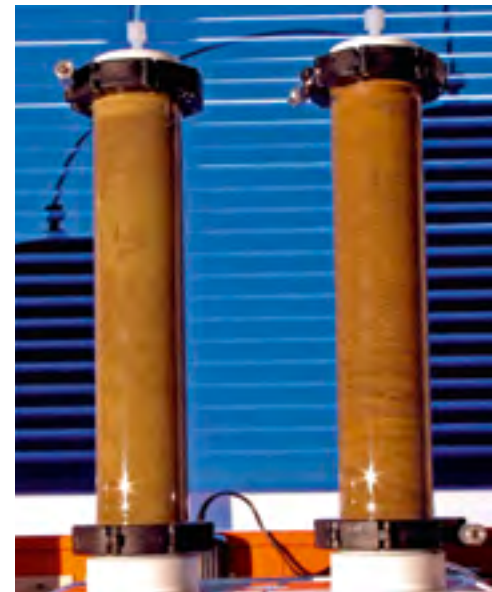
Mit einem Säulenversuch können Schadstoffe im Sickerwasser von belasteten Böden bestimmt werden.
