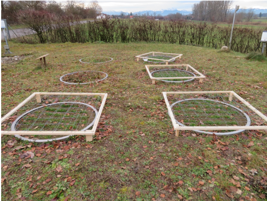
Abb. 7: Drahtgestellabdeckung der Lysimeter zum Schutz der Bepflan- zung
