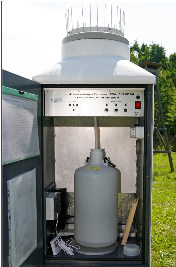
Abb. 66: Gekühlter Nieder- schlagssammler mit PE-Sammelflasche.
