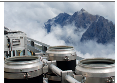
Niederschlagssammler, die den hochalpinen Bedingungen standhalten, nehmen Regen, Schnee und Staub auf. In ihnen läuft der Niederschlag über ein Material, das Schadstoffe herausfiltert. Nach seinem Einsatz wird das Material in Ultraspurenlaboren auf Schadstoffe untersucht.
