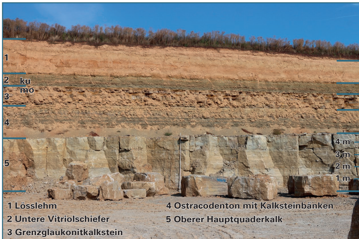
Abb. 5: Steinbruch-Profil aus dem Sellenberger Abbauggebiet. Der Quaderkalk ist hier etwa 4,5 m mächtig und wird von 9 m Abraum bestehend aus Lösslehm (Quartär), unterem Vitriolschiefer (Unterer Keuper), Grenzglaukonitkalkstein und Ostracodenton mit Kalksteinbänken überlagert (beide Oberer Muschelkalk, die unterste Kalksteinbank im Ostracodenton wird als „Zugbank“ im Ostracodenton bezeichnet siehe Tab. 1).
