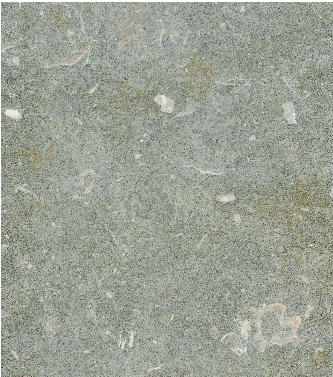
Abb. 25: Musterplatte aus Regensburger Grünsandstein von Ihrlenstein (DBU Projekt P406).
