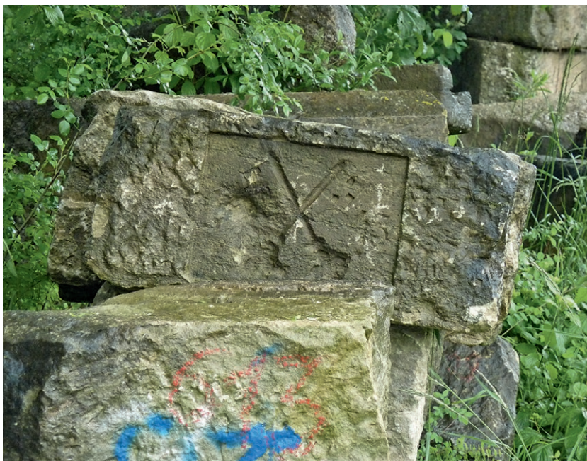
Abb. 3: Lagernde Blöcke von Regens- burger Grünsandstein am Bau- hof Regensburg.
