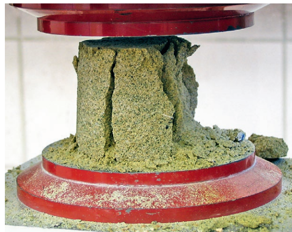
Abb. 6: Prüfzylinder nach Bruch.
