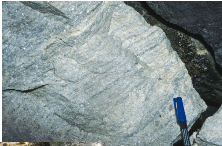
Gebänderter kristalliner Marmor aus dem Steinbruch bei Rathmannsdorf mit angewitterter Oberfläche (links) und im frischen Bruch (oben).
