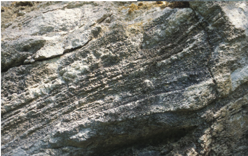
Gebänderter kristalliner Marmor aus dem Steinbruch bei Rathmannsdorf mit angewitterter Oberfläche (links) und im frischen Bruch (oben).
