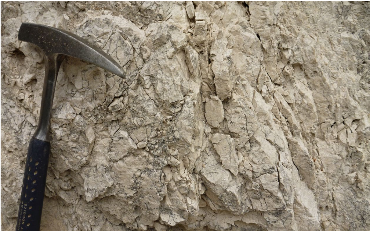
Abb. 41: Weißgrauer, massiger Dolomitstein, stellenweise mit unregelmäßigen Hohlräumen, brecciiert und unregelmäßig geklüftet, Ramsaudolomit (Maiswandgraben, N Bischofswiesen)
