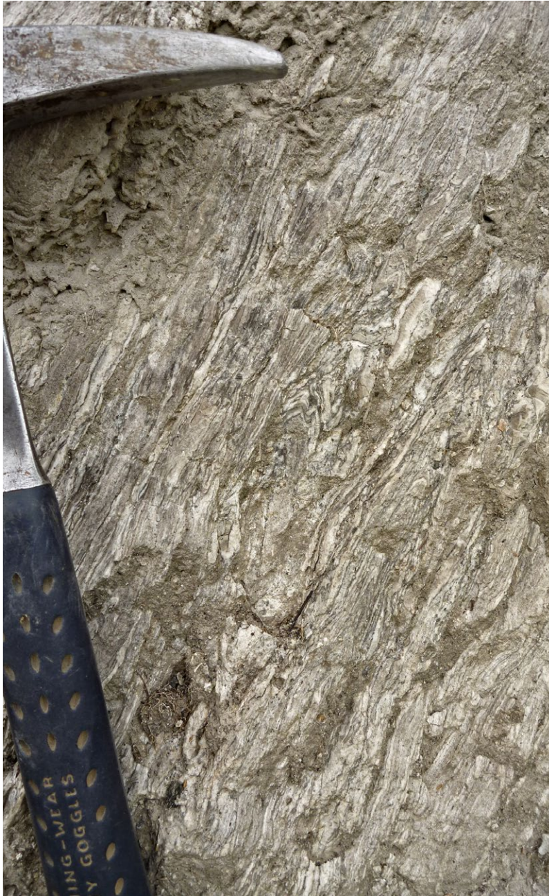
Abb. 54: Feinlaminierte, verfaltete Wechselfolge aus weißem Gips und grauem Tonstein, Raibler Gips, Raibl-Formation (Oberau)
