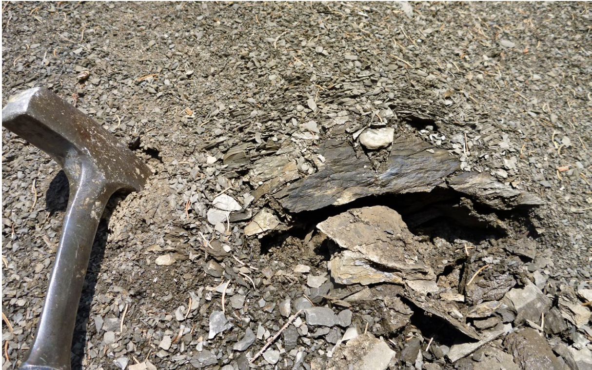
Abb. 35: Die schwarzgrauen Tonmergelsteine zerfallen leicht zu blättrigem Grus, Partnach-Formation (Ferchenbach, SE Garmisch-Partenkirchen)
