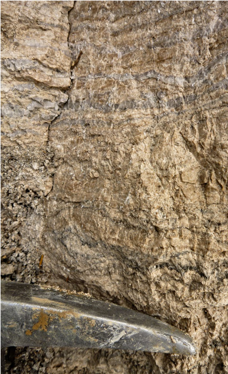
Abb. 61: Hellbeiger, laminiertes Dolomitstein mit schwarzgrauen bituminösen Lagen, Hauptdolomit (Steinbruch, S Fischbach am Inn)
