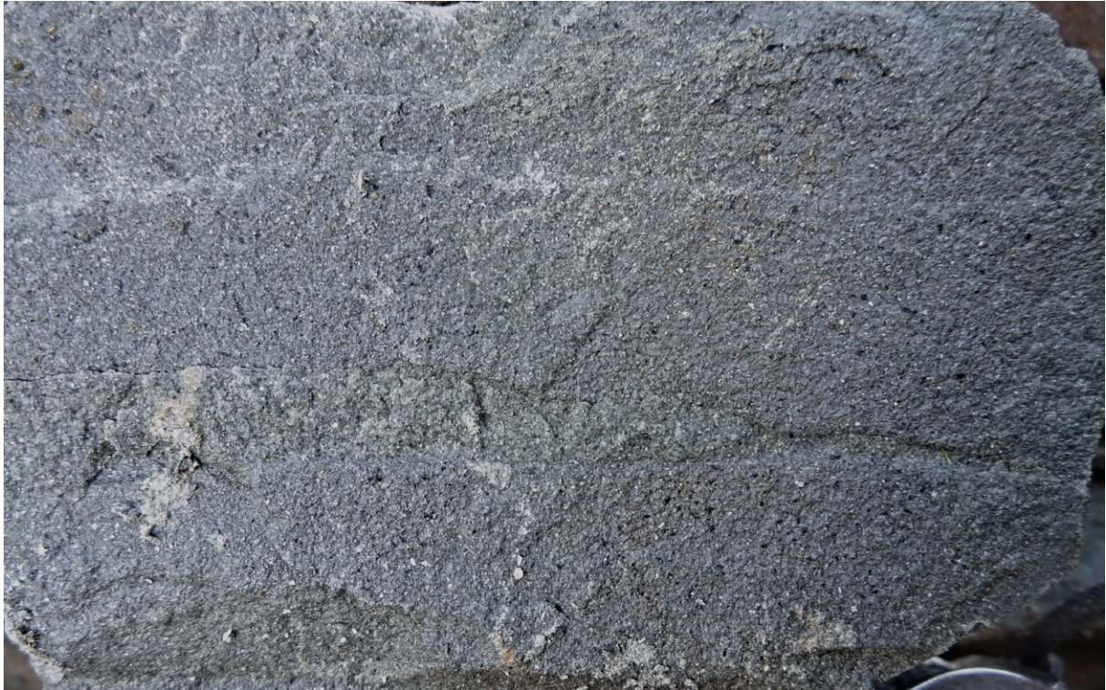
Abb. 43: Schwarzgraue, karbonatisch gebundene Feinsandsteine, mit feinem Muskovit und inkohlten Pflanzenhäckseln auf den Schichtflächen, Raibl-Formation (Steinbruch, S Fischbach am Inn)
