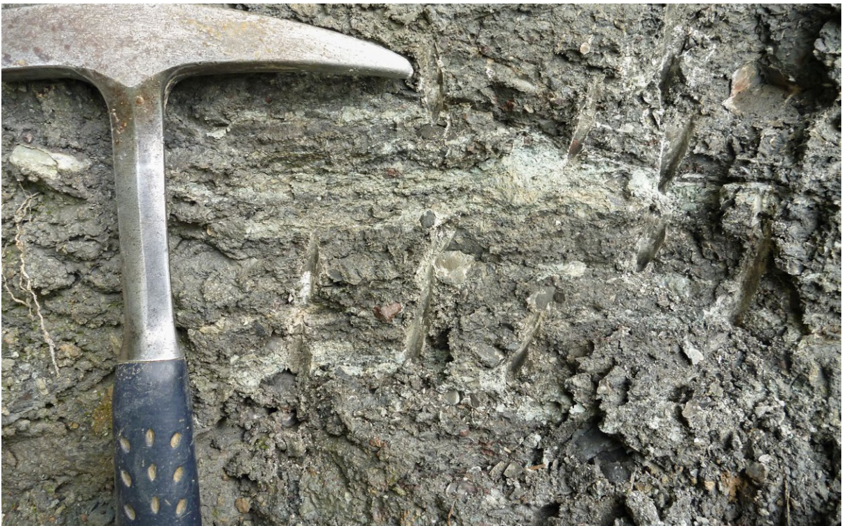
Abb. 9: Dunkelgrauer, gebänderter, schwach plastischer Ton-Schluff, stellenweise Gips-führend, verwittertes Haselgebirge (Höllgraben, SE Mitterbach)
