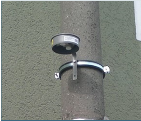
Abb. 4: Wetterschutzgehäuse mit Passivsammlern; die beiden Sammeleinheiten sind als weiße Plastikkapseln gut zu erkennen
