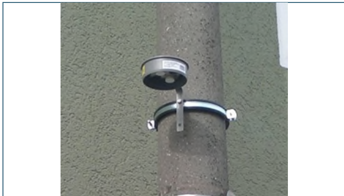
Abb. 4: Wetterschutzgehäuse mit Passivsammlern; die beiden Sammeleinheiten sind als weiße Plastikkapseln gut zu erkennen
