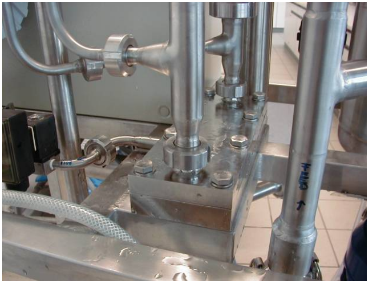
Abbildung 7 Versuchsaufbau Membranfiltration. Links: Plattenmodul. Rechts: Membranteststand.
