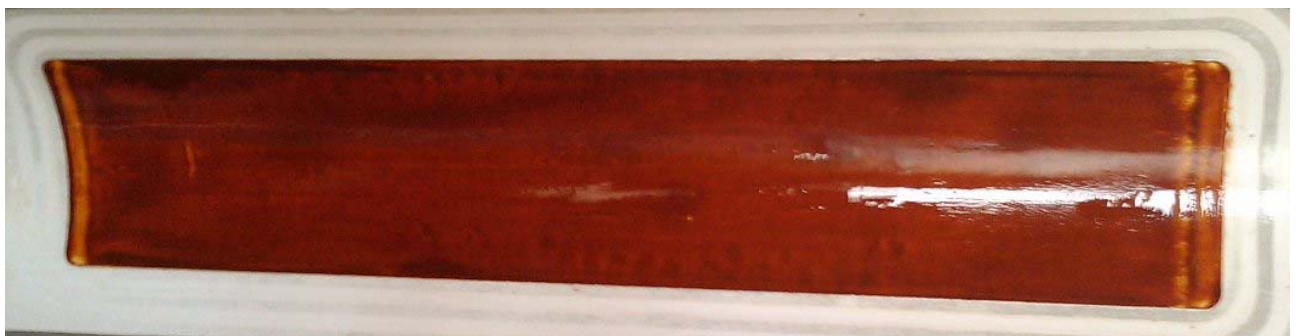
Abbildung 9 Membran XLE nach Versuchsabschluss.
