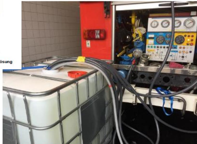
Abbildung 4: Entnahme der ersten „fetten PerfluorAd-Spüllösung“ nach erfolgter Entleerung des Schaummittelkonzentrats aus dem Einsatzfahrzeug
