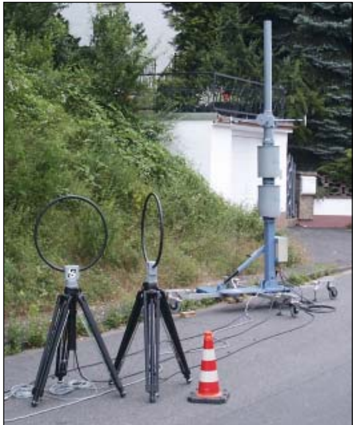
Abb. 11: Hochfrequenzmesssystem bestehend aus Antennenturm und Rahmenantennen
