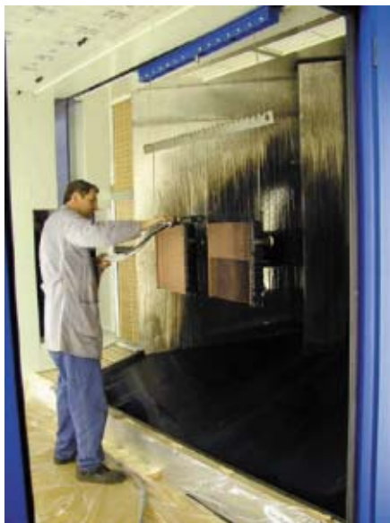
Lackrückgewinnung durch Kondensation
