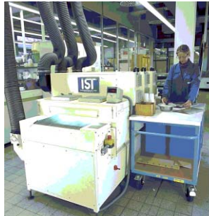
Übliches Labor UV-Bandgerät Lampe: Hg 120W/cm
