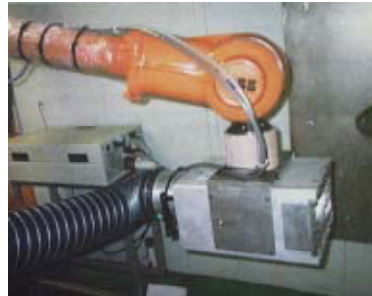
3D-UV-Einheit (Roboter) (P. Burger, besser lackieren, 15/2000, p.535.)
