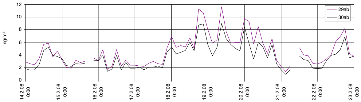
Abbildung A.5-23: Verlauf der Konzentration von 17 \alpha (H),21 \beta (H)-30-Norhopan und 17 \alpha (H),21 \beta (H)-30-Hopan im Zeitraum 13.02.2008 18:00 – 22.02.2008 24:00, 3h Mittelwerte, SP1
