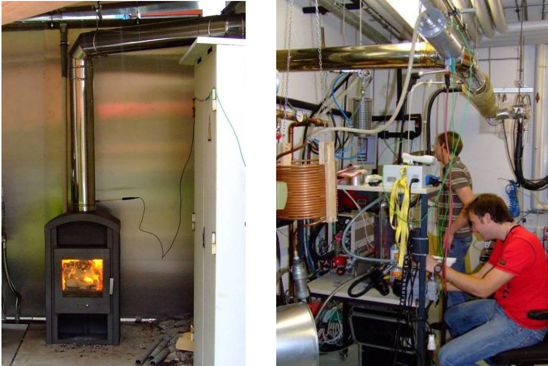
Abbildung 2.2-1 Emissionsmessung am ZAE Bayern in Garching Links: Aufstellung des Prüflings, rechts: Messstrecke im Labor mit Probenahmestellen und Messgeräten
