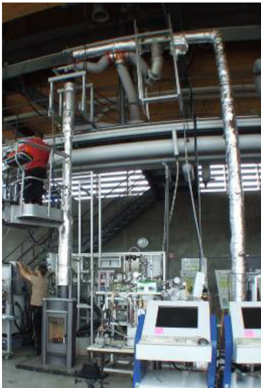
Abbildung 2.2-3: Emissionsmessung am Prüfstand des TFZ mit Verdünnungstunnel
