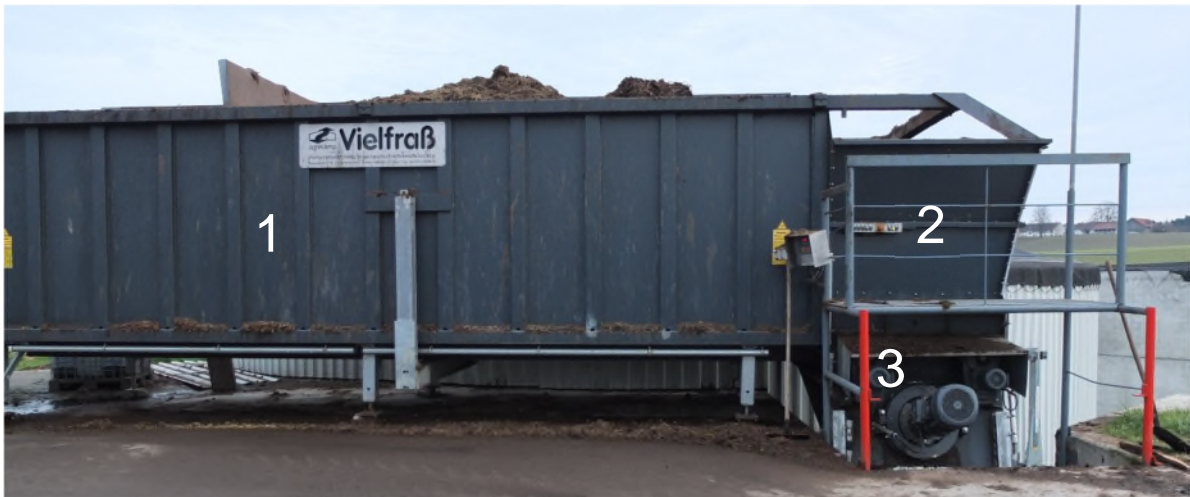
Abbildung 21: Vorlagebehälter (1), Austragsystem (2) und Einbringsystem (3) eines Feststoffeintrags (Foto: LfL)
