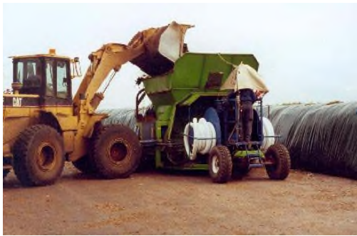
Abbildung 19: Beladevorgang eines Folienschlauches / Folienschlauchverfahren zur Feststofffermentation (Lfl. 2007)
