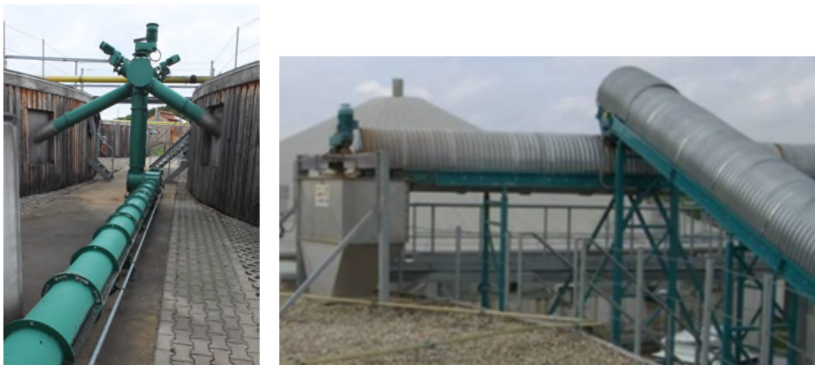
Abbildung 22: Eintragungssysteme mit Förderschnecken (links) und Förderbändern (rechts) (LfL)
