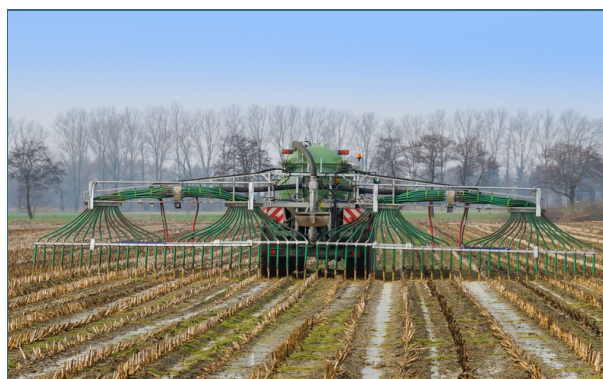
Abb. 3: Günstig ist die Ausbringung mit dem Schleppschlauchverteiler kurz vor dem Regen. Dann sickern Gülle oder Dünger rasch ein.
