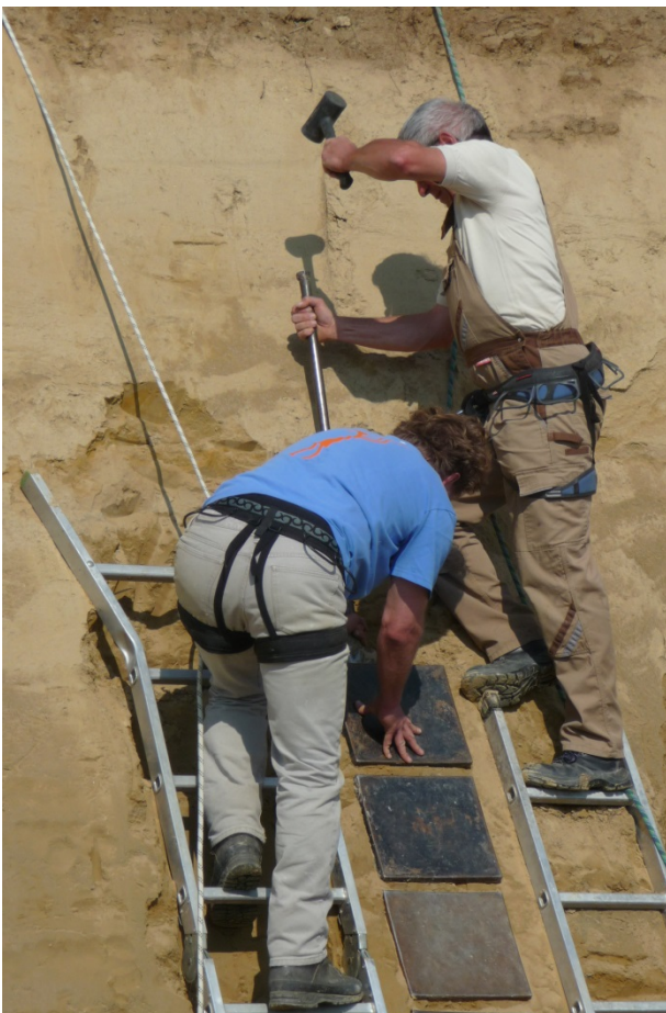
Abb. 3: Rechteckige Stahlkästen werden in die Wand der Kiesgrube geschlagen. So drückt sich der Boden in den Kasten und kann vorsichtig aus der Wand gelöst werden.
