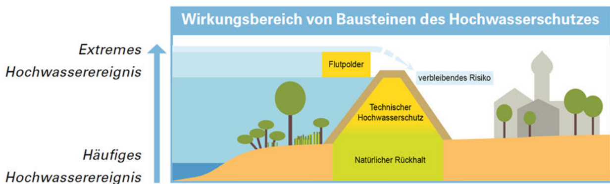
Abbildung 3: Bausteine eines modernen resilienten Hochwasserschutzes
