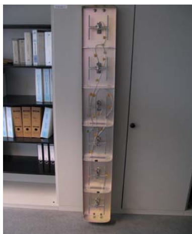
Abb. 6.9: "Innenleben" einer GSM900-Antenne (älterer Typ). Sie besteht aus sechs Dipolpaaren, die übereinander angeordnet sind.
