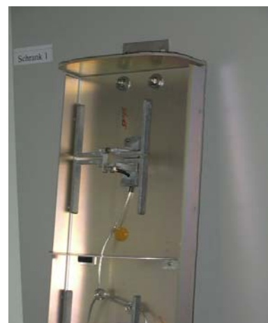
Abb. 6.9: "Innenleben" einer GSM900-Antenne (älterer Typ). Sie besteht aus sechs Dipolpaaren, die übereinander angeordnet sind.
