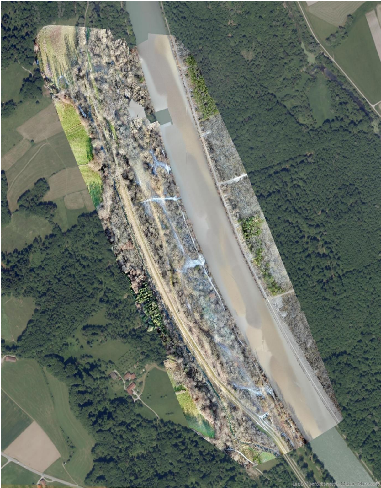
Abb. 10: Ein aus über 1.200 einzelnen Drohnenbildern erstelltes, georeferenziertes Orthofoto von der geplanten Renaturierungsfläche an der Salzach bei Tittmoning (im Zentrum, hellere Färbungen, Auwald in Graubraun). Drohnen können die Arbeitsverläufe dokumentieren. Das darunterliegende Satellitenbild (Wälder in Dunkelgrün) verdeutlicht die sehr hohe Auflösung und die recht präzise Georeferenzierung des Drohnen-Orthofotos. Foto: LfU, M. Mitterbacher
