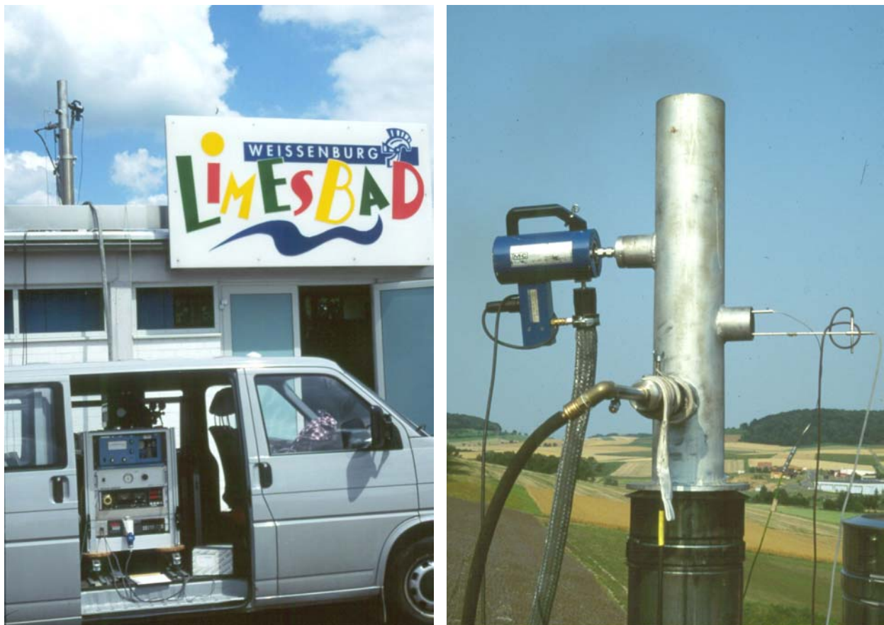
Abbildung 8: Kaminaufsatz bei den wiederkehrenden Emissionsmessungen am BHKW in Weißenburg (links) und in Greußenheim (rechts)
