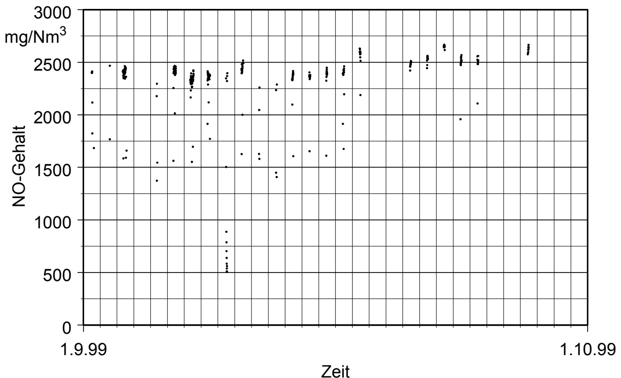
Abbildung 60: NO-Emissionen bei den Daueremissionsmessungen am BHKW Weißenburg im September 1999– Emissionswerte bezogen auf trockenes Abgas unter Normbedingungen (0 °C, 1013 mbar) und 5 % O 2
