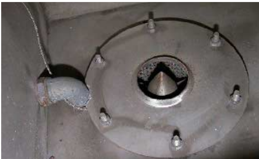
Bild 7.1-2: Filterelement mit Abdeckblech und Heizelement/ Strömungsleiteinrichtung
