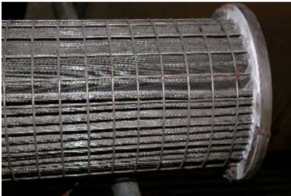
Bild 7.2-5: Patrone nach erfolgter manueller Reinigung
