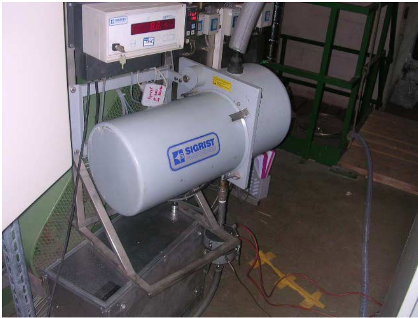
Bild 6.3-1: Photometer zur Bestimmung der relativen Staubkonzentration im Rauchgas
